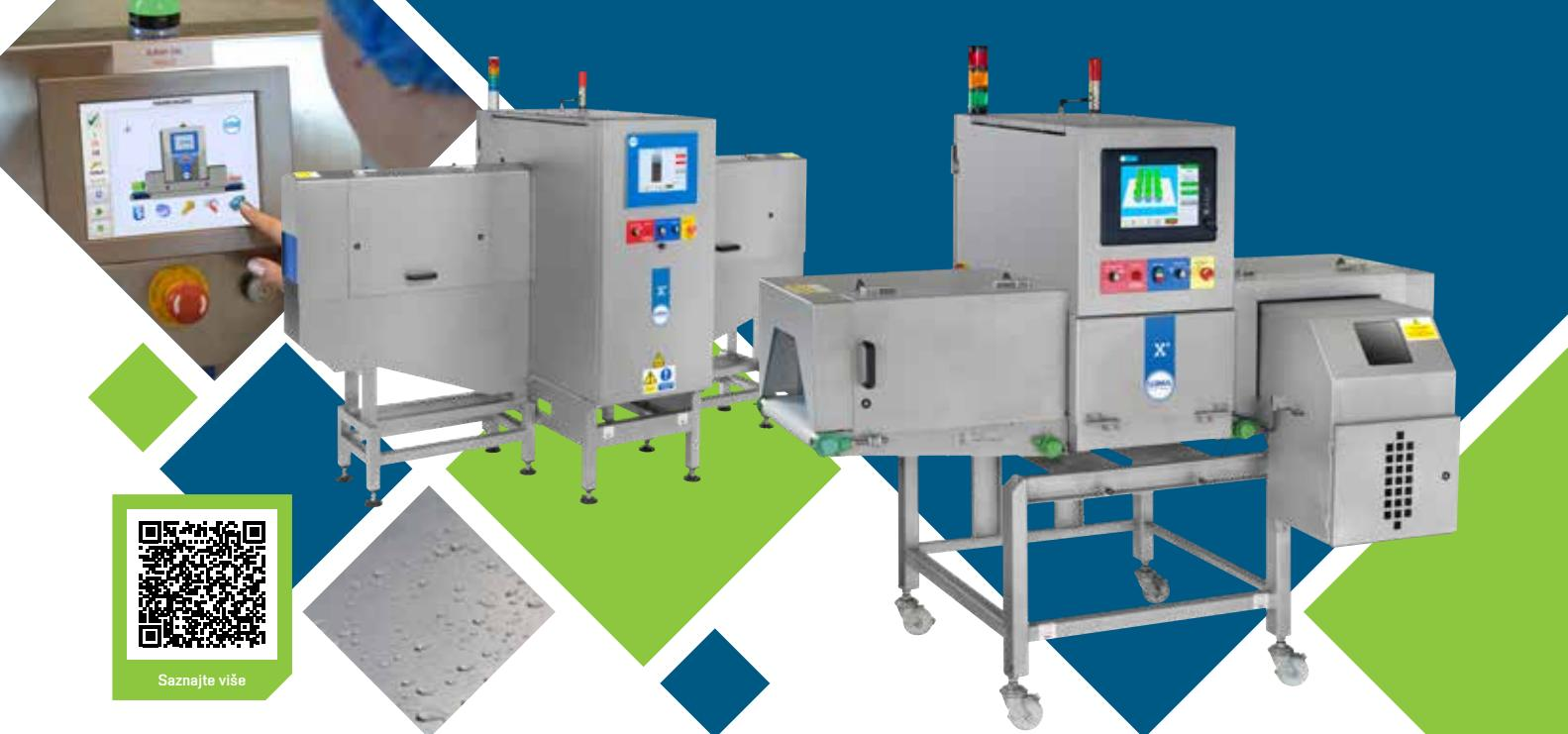
Jedinica ima full grafički touch screen ekran i proizvedena je od nerđajućeg čelika kako bi obezbedila higijensko ispitivanje u skladu sa okolinom i lako čišćenje. Loma IQ+ farmaceutski metal detektori su odgovarajući za sve vrste pilula. Cela jedinica je dizajnirana po principu potpuno integriranog hardvera što znači da ne postoje delovi koji su izdvojeni i da se može lako i brzo montirati/demontirati.
